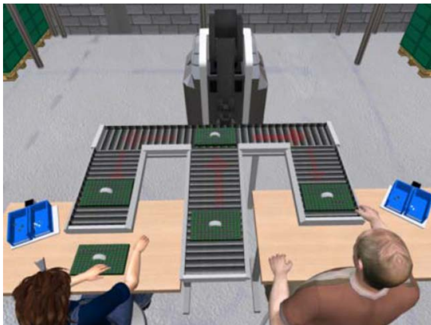
Abbildung 4: Dritter Entwurf des MRK-Arbeitsplatzes: Arbeitsplatz für bis zu 3 Mitarbeiter mit V-förmig angeordneten Leisten für die Düsenbestückung
