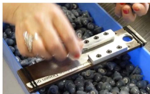
Abbildung 1: Ausgewählter Ausgangsarbeitsplatz für einen Mitarbeiter mit den manuellen Teiltätigkeiten Fügen und Prüfen der Düsenelemente.
