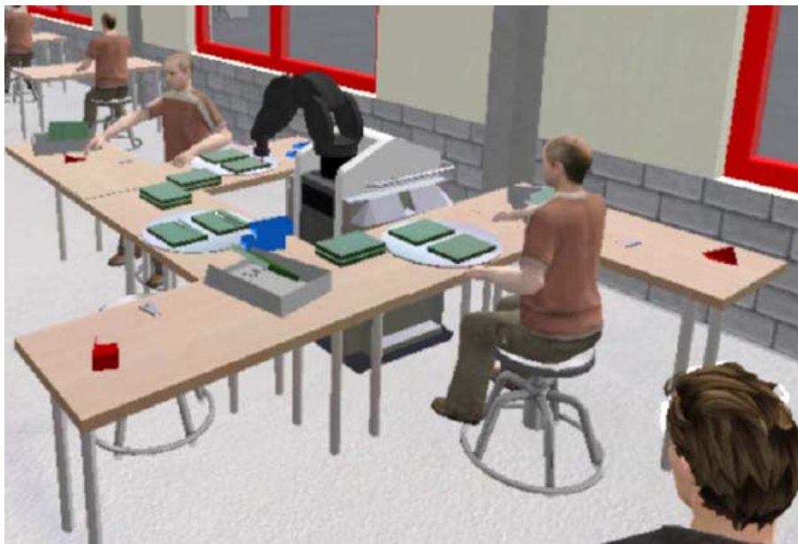
Abbildung 3: Zweiter Entwurf des MRK-Arbeitsplatzes: Arbeitsplatz für bis zu 3 Mitarbeiter mit geteiltem Drehteller und der rechts im 90-Grad-Winkel angebrachten Prüfschiene
