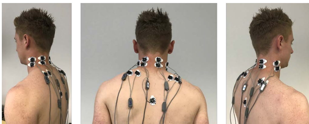
Abbildung 2: Positionierung der Oberflächenelektroden auf der zu untersuchenden Muskulatur im Hals-, Nacken- und Schulterbereich am Beispiel einer Versuchsperson
