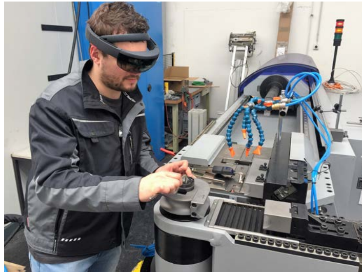
Abbildung 1: Darstellung des möglichen Einsatzszenarios der Microsoft HoloLens im Zuge des Rüstvorgangs einer Rotationszugbiegemaschine
