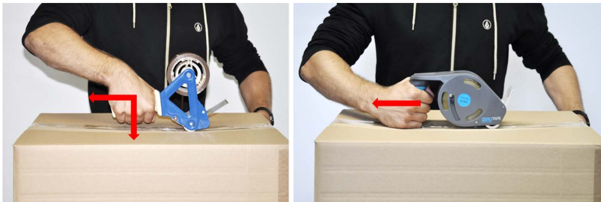
Abbildung 5: Darstellung der verschiedenen Kopplungsarten bei der Verwendung des Standardabrollers (links: Reibschluss) und des ZeroTape (rechts: Formschluss). Rote Pfeile markieren die entsprechenden Krafrichtungen.
