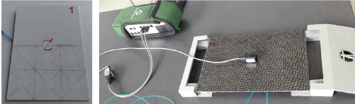
Abbildung 2: Von links nach rechts: Messpunkte zur Vibrationsmessung auf dem Material A und Beschleunigungssensor auf einer Materialprobe in der Plattenauflage
