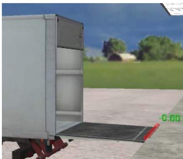
Abbildung 2: Dynamisches VR-Modell des Lkws mit verschobener Hubladebühne nach Entladevorgang
